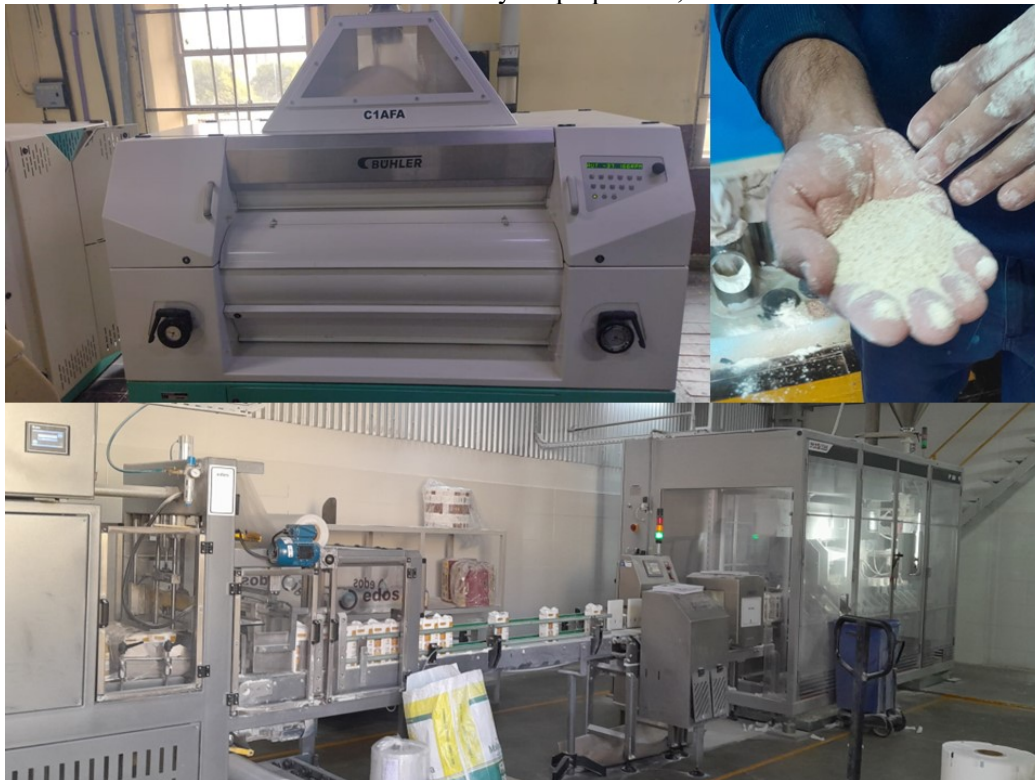
Imagen 8. Proceso industrial de molienda y empaque. Arriba: bancos de cilindros. Abajo: fraccionamiento y empaquetado, 2023
